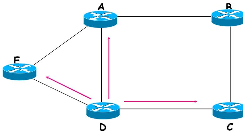
LSP trasmesso dal router D a tutti i router adiacenti
